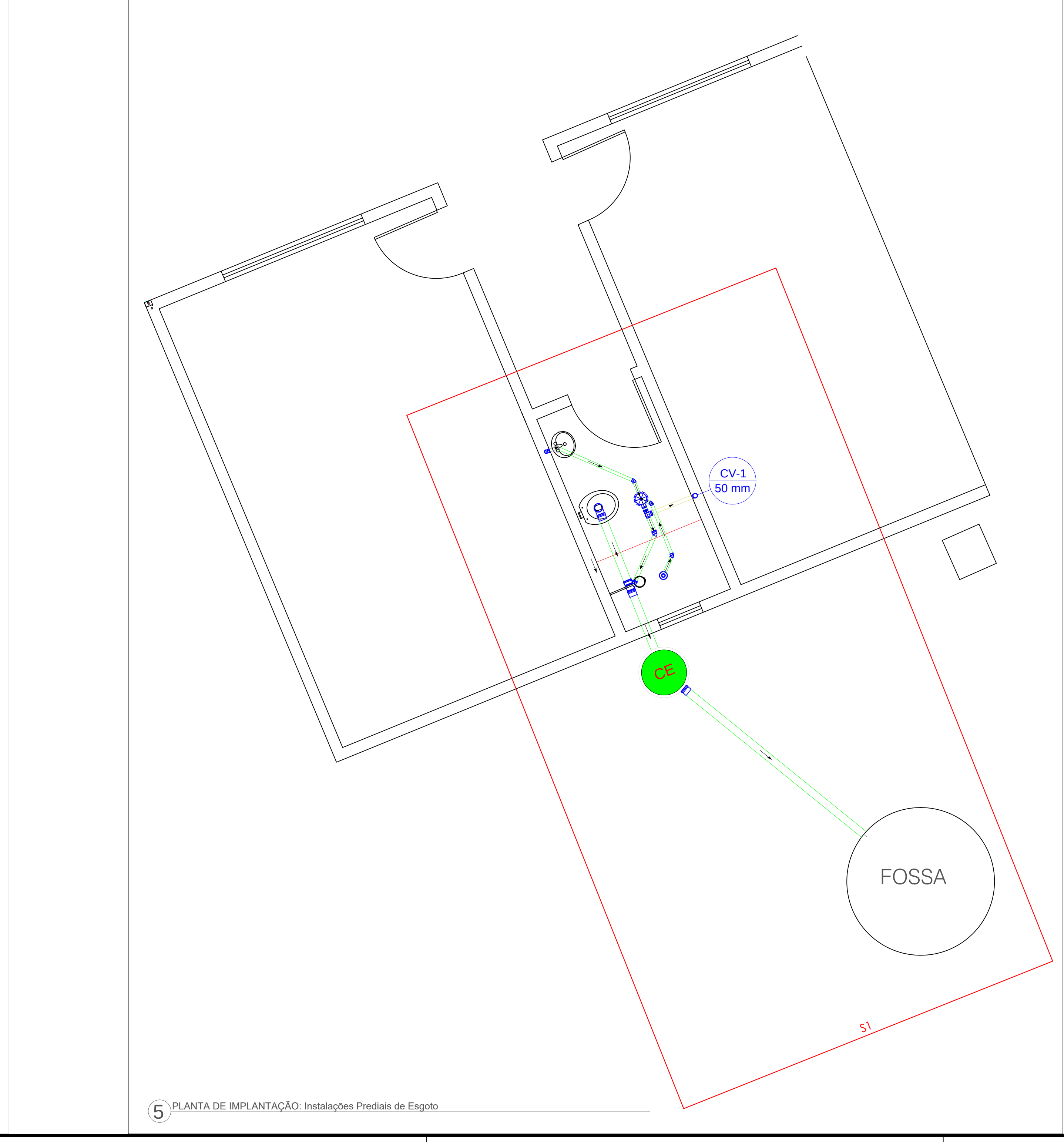
5 PLANTA DE IMPLANTACÃO: Instalações Prediais de Esgoto
